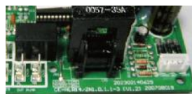
Вывод сигнала релейной защиты фазы
