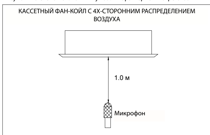
Рисунок №6 Схема испытаний шумовых характеристик агрегатов
